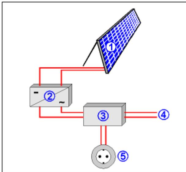
Gli impianti FV a immissione in rete possono essere definiti come centrali elettriche. Essi infatti forniscono l'energia solare trasformata direttamente alla rete pubblica di distribuzione dell'energia elettrica. Questi tipi di 'centrali', contrariamente ad altri tipi, sono già oggi realizzabili in forma ridotta (potenza di pochi watt) fino ai grandi impianti (potenza di diversi megawatt).
