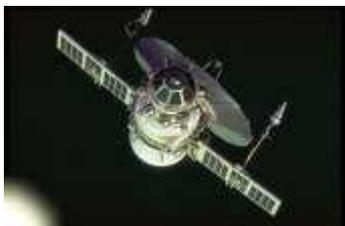
Sebbene l'effetto fotovoltaico venne scoperto già nel 1839, le prime applicazioni pratiche nacquero solo negli anni cinquanta. Il FV (fotovoltaico) venne sviluppato per i primi satelliti, che furono messi in orbita in quel periodo. Le tradizionali pile, batterie a combustione e l'energia nucleare non erano adatte alle esigenze di allora: dopo un breve periodo l'energia immagazzinata si sarebbe consumata ed il satellite sarebbe divenuto inutilizzabile.
